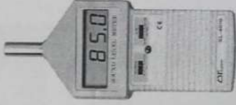
شكل (4): جهاز مقياس مستوى الضوضاء والمعاير مسبقاً عند 114 ديسيبل
