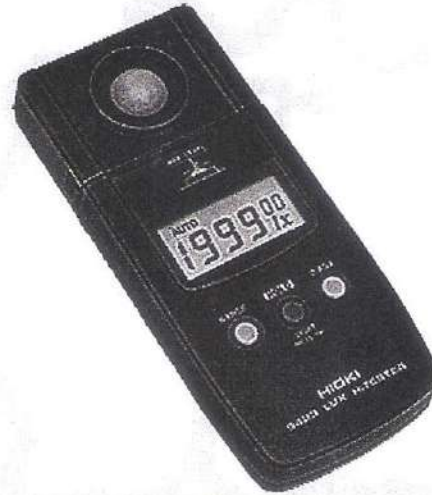
شكل (٥): جهاز لوكس ميتر
