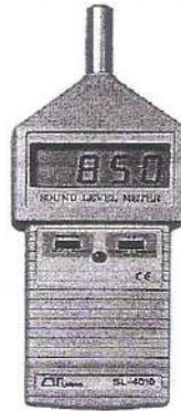
شكل (٤): جهاز مقياس مستوى الضوضاء والمعاير مسبقا عند ١١٤ ديسيبل
