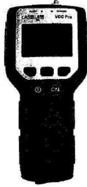
شكل (٦) : جهاز قياس الأبخرة العضوية الكلية
