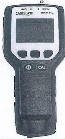
شكل ٦: جهاز Photoionization Detector
